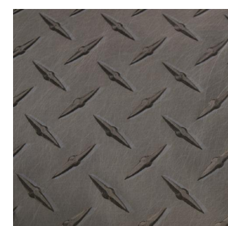
materiál lávky broušený nerezový plech opatřen protiskluzovým vzorem
