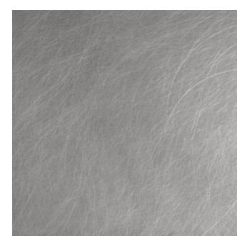
materiál obručí broušený nerezový plech
