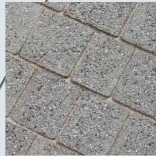
betonová mozaika skládaná do řádku velikost dlažby: 100 x 100 mm výška pojezdové dlažby: 80 mm, pochozí dlažba 60 mm
