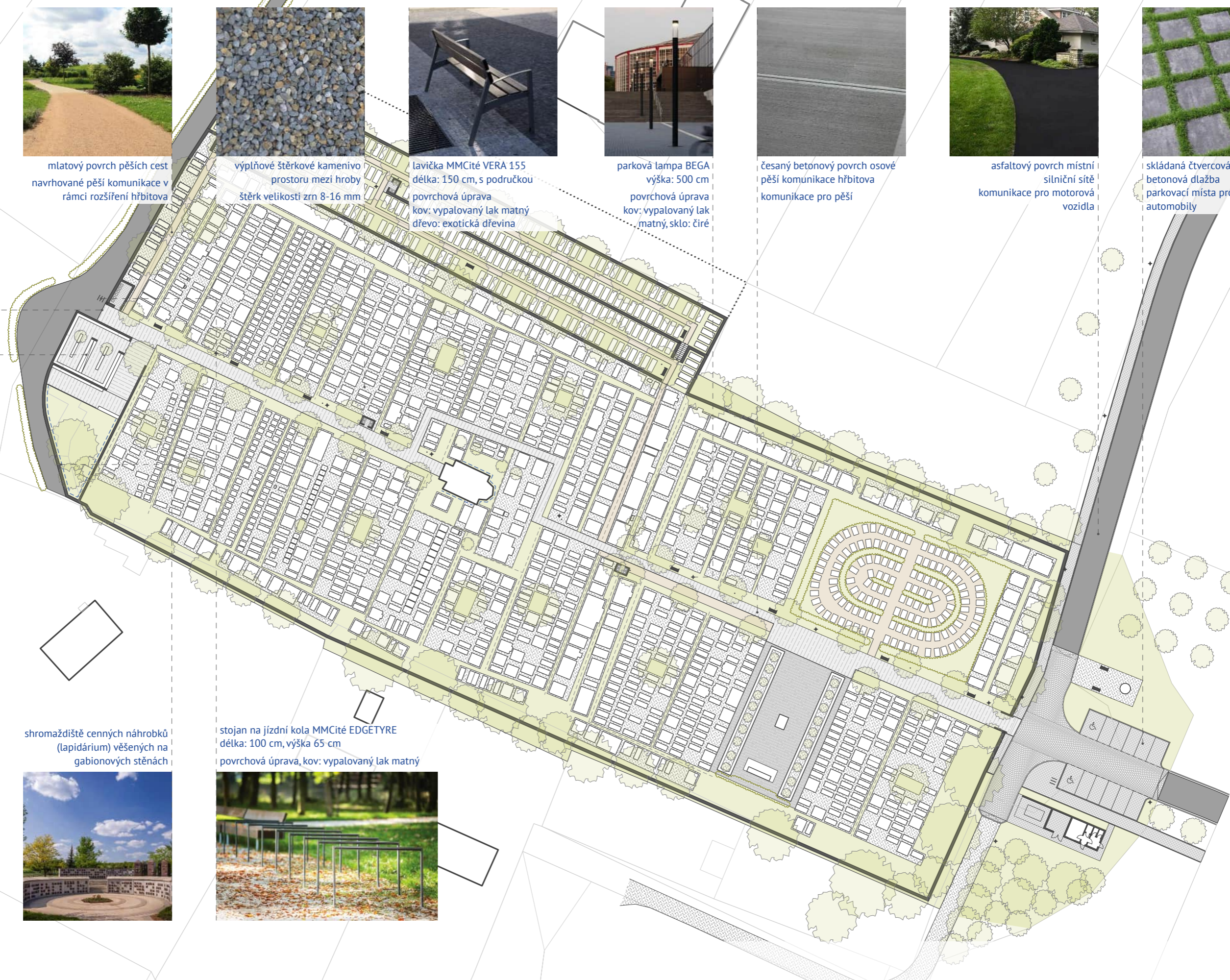
gabionové opěrné stěny tvořící oplocení hřbitova, doplněné o kortenové prvky (popis, vrátka) nerezové síťované koše vyplněné skládaným kamenivem
