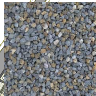
výplňové šterkové kamenivo prostoru mezi hroby šterk velikosti zrn 8-16 mm
