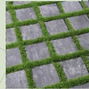
skládaná čtvercová zatravnňovací betonová dlažba velikost: 200 x 200 mm včetně 30 mm spáry, výška 80 mm parkovací místa pro osobní automobily
